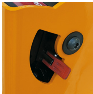
△ Imposible que el tambor se suelte con carga (excepto VS 250/320 sin liberación del tambor).
