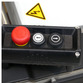
▶ Control colgante IP66. Cable eléctrico de tipo marino (sin halógeno). Enchufe de tipo Harting. Protección IP66.
