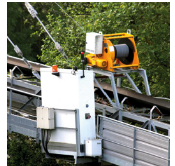
▷ Elevación de la cinta transportadora para cargar pontones.
