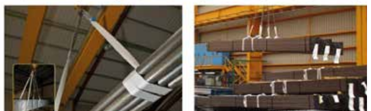
Forma correcta de trabajo con las eslingas de un solo uso
