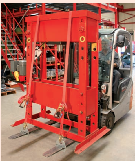
Fissaggio del carico con morsetti per forche e cinghie di fissaggio
