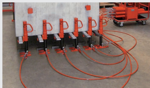
Gruppo pompa speciale per il sollevamento sincrono con 12 binde. Bloque de presión especial para elevación sincrónica con 12 Gatos hidráulicos.
