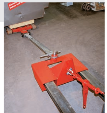
Dispositivo di aiuto alla manovra JRH 3 in uso. La ayuda de maniobra JRH 3 en uso.
