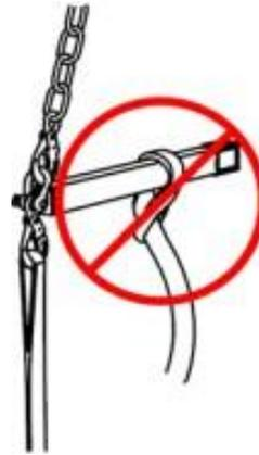
Figura 4: ¡Queda **terminantemente prohibida** la fijación en cualquier otro lugar que no sea el punto de fijación (grilletes)!
