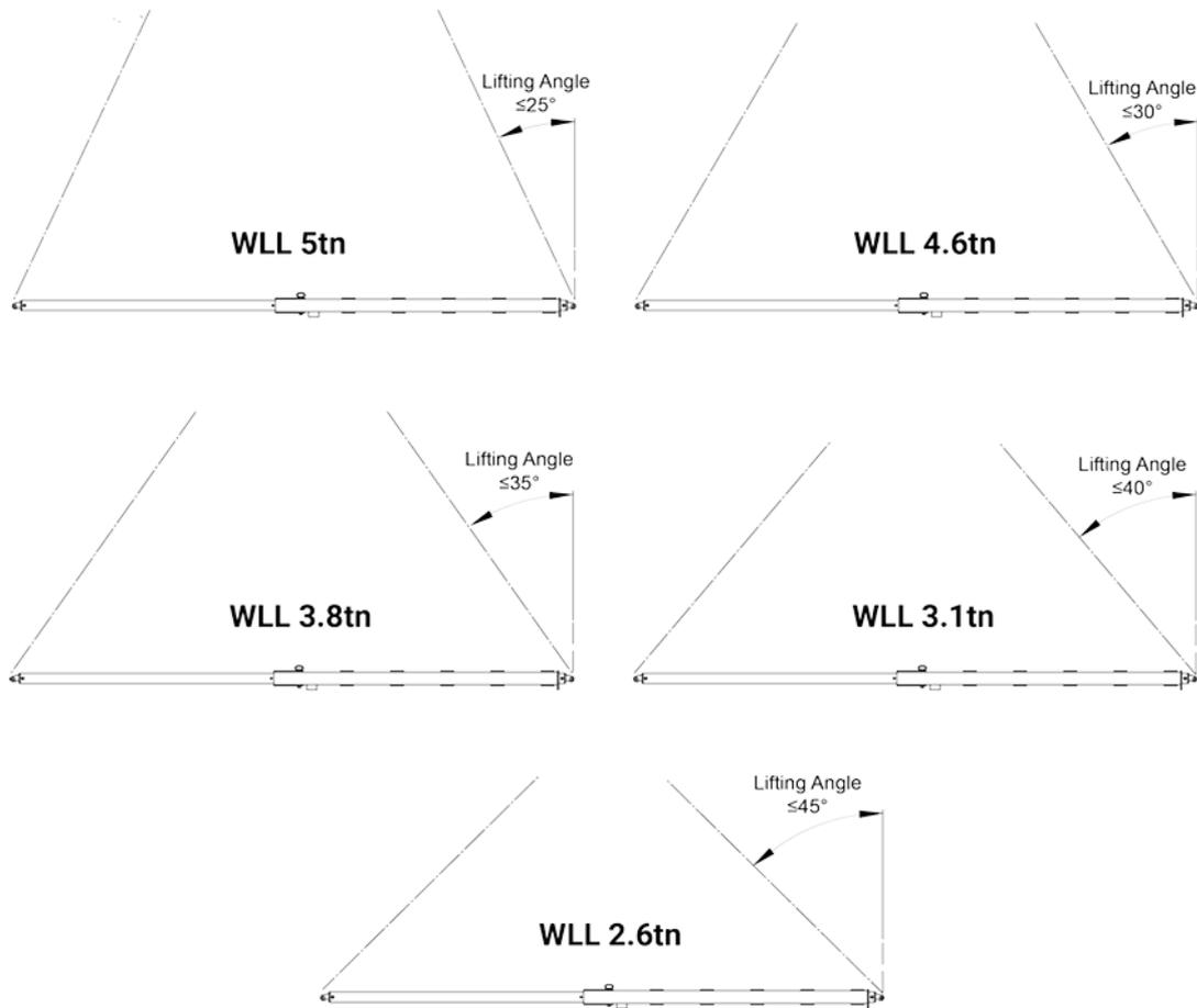
*Ilustración 2* Capacidad de carga 5t (CMU) hasta un ángulo de elevación de  $\beta$  igual o menor a  $25^\circ$ , menor capacidad de carga para un ángulo de elevación mayor a  $\beta$ , máx.  $40^\circ$ .
