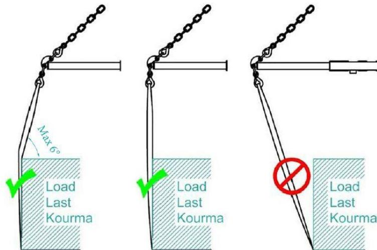
*Ilustración 3* La longitud del balancín no mayor que la distancia entre los puntos de fijación. Inclinación máxima permitida de 6° con la vertical.
