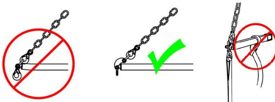
*Ilustración 4.* Solo se permite ajustar los ramales y eslingas mediante la argolla de elevación.
