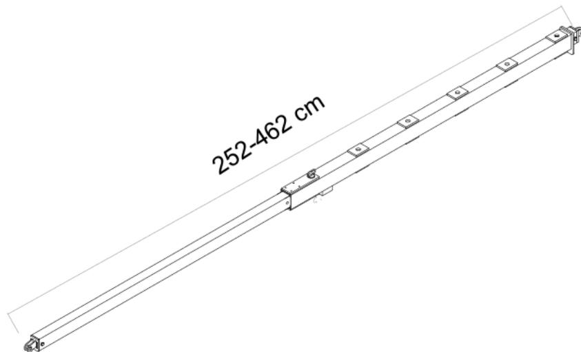
*Ilustración 1* El balancín extendido en máximo (longitudes en cm de mínimo y máximo).
